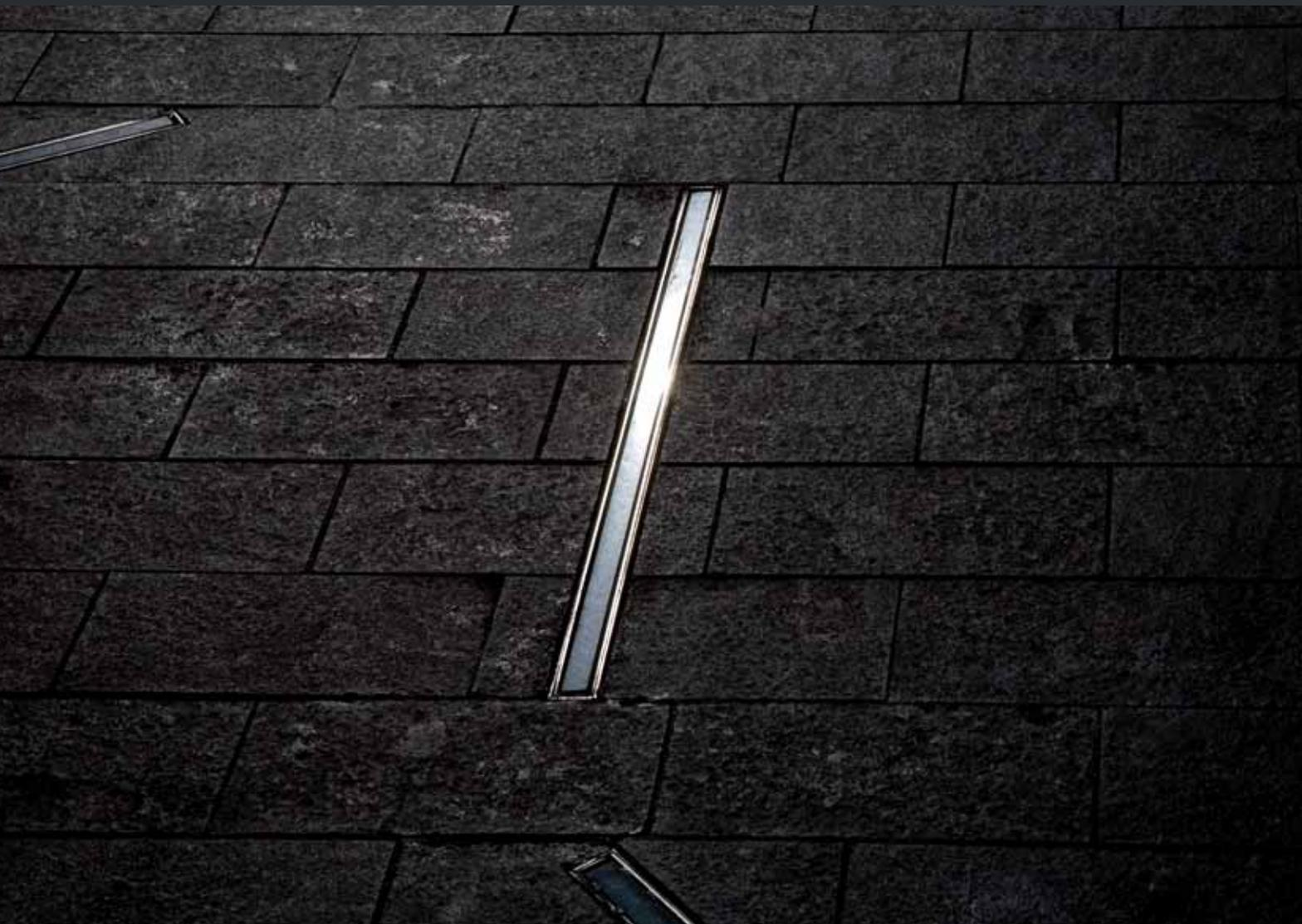
La luminaria NAIDA se ofrece en dos tamaños con un cuerpo de acero inoxidable, difusor de vidrio laminado opal y LEDs SMD disponibles en monocolor como en RGB. Posibilidad de iluminación estática y dinámica gracias a los protocolos de comunicación DMX o DALI que permiten regular y combinar colores para la elaboración de escenarios lumínicos.
