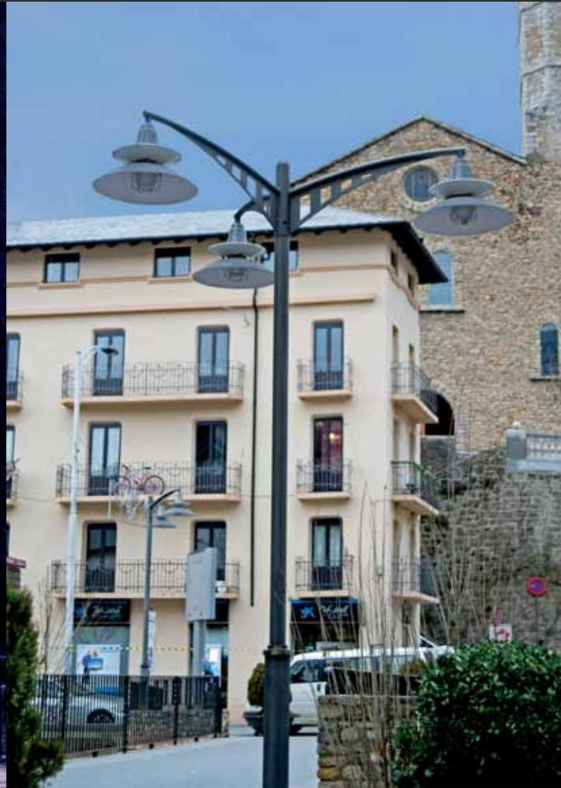
Es posible escoger entre dos tipos de fijación, a catenaria o suspendida. Dado su carácter urbano la potencia máxima que se puede utilizar es 100W tanto de halogenuros metálicos como vapor de sodio.
