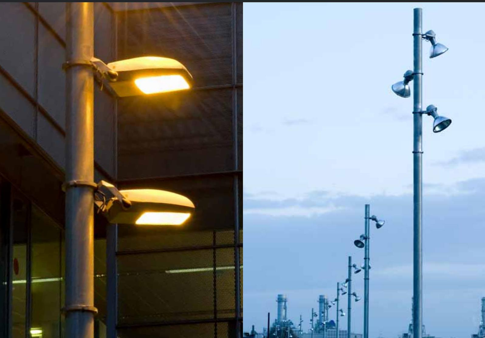
La columna se ofrece en 4 alturas, 9, 12, 14 y 16 metros. En función de la altura se pueden encontrar un cierto número de anillos que sirven para fijar los proyectores con la posibilidad de decidir en intervalos de  $120^\circ$  el ángulo de colocación. TOWER está fabricada en tubo estructural de acero galvanizado pudiéndose pintar bajo demanda.
