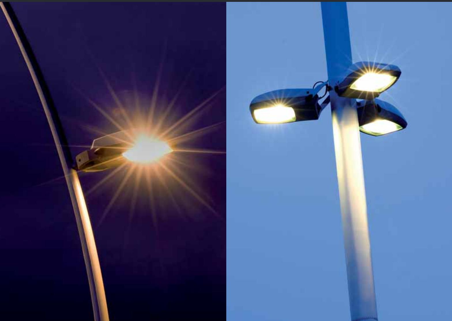
El proyector ETNA abarca un gran rango de potencias hasta llegar a los 600W. Puede incorporar 6 diferentes reflectores (asimétricos, simétricos, cónico y vial) así como 3 tipos de sistemas de fijación para adecuarse a distintas aplicaciones (post-top o lateral, a cruceta o mural).
