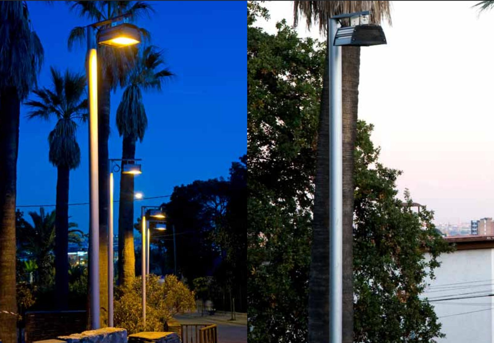
La TIL es una columna tubular de acero. Las alturas en que se ofrece van desde los 4m hasta los 9m con intervalos de medio metro. En función de la altura el diámetro varía, hasta 7,5m es  $\varnothing$  127 y a partir de 8m es  $\varnothing$ 152.
