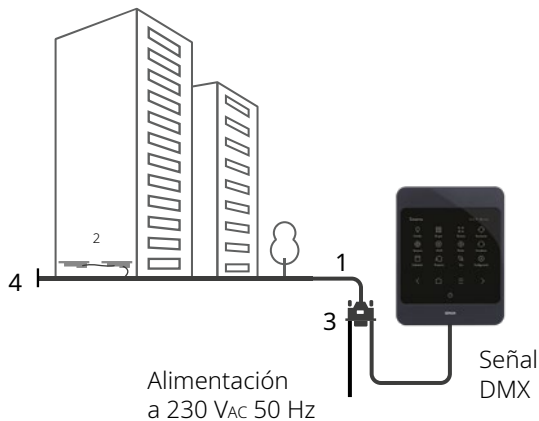
Instalación con máximo 15 Luminarias
