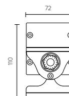
De superficie, regulable con radio de giro reducido para la orientación del flujo lumínico (95°). Altura de la luminaria reducida. Sistema recomendado para la iluminación de objetos como monumentos, grandes objetos, etc.
