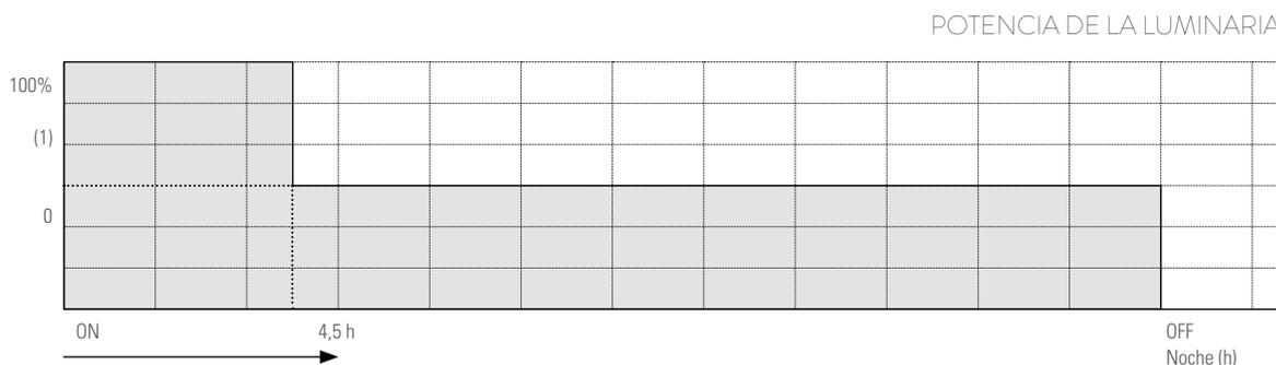
Encendido y apagado según línea de alimentación de armario eléctrico
