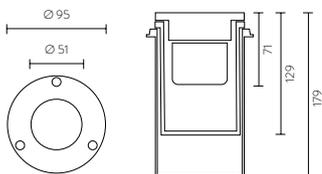
**Fijación** Empotrado a suelo. Requiere cajetín de instalación código 11-1040-000 para montaje de cemento/hormigón.
